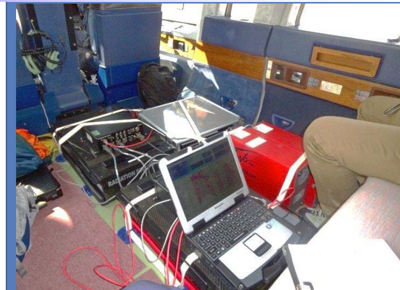
航空機に搭載した状態の検出器
